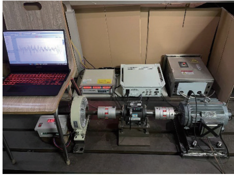
图 1 船舶用电机试验台架 Fig. 1 Experimental setup for ship motor
