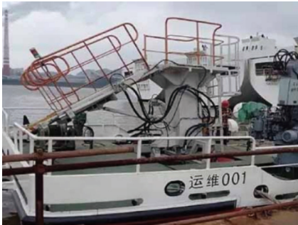
图 2 广船院小型登离舷梯 Fig. 2 Small offshore gangway of GSERI
