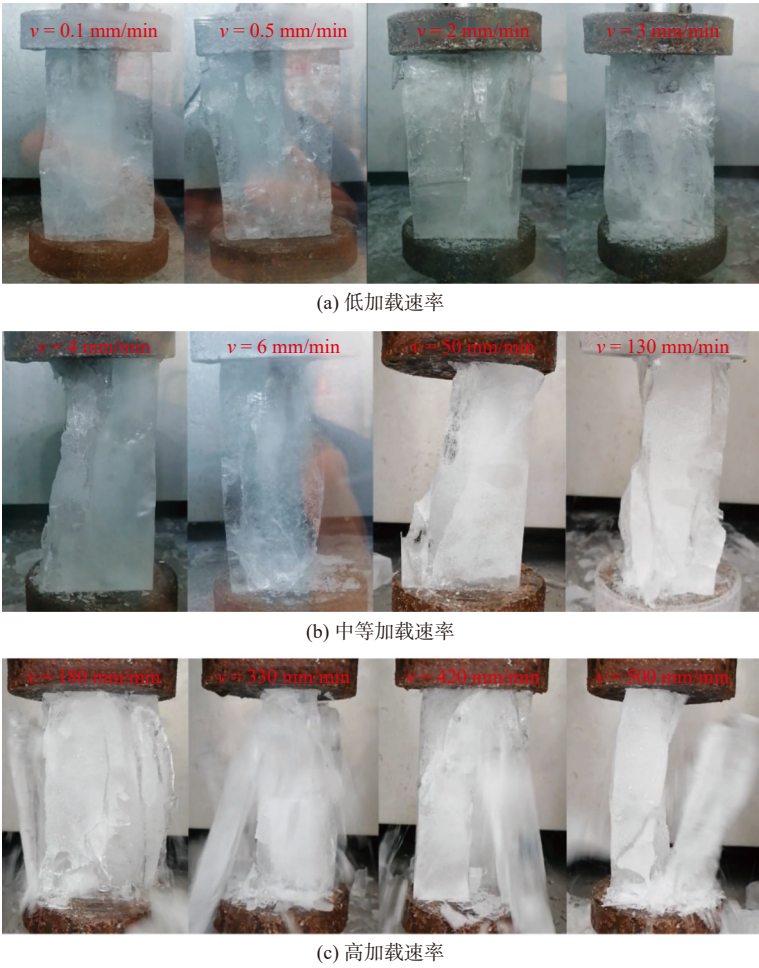
图 6 不同加载速率时的淡水冰试样的破坏模式
